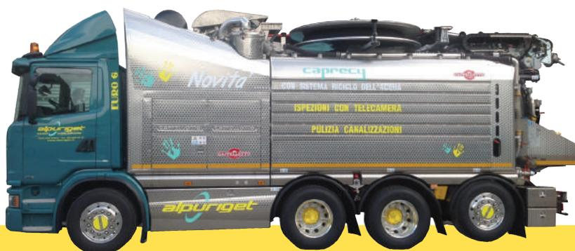
Il Camion cisterna **CAP RECY**, studiato per la pulizia idrodinamica di canalizzazioni e condotte, opera in modo rapido, efficiente ed economico, recuperando l'acqua di lavaggio per utilizzarla a ciclo continuo.
