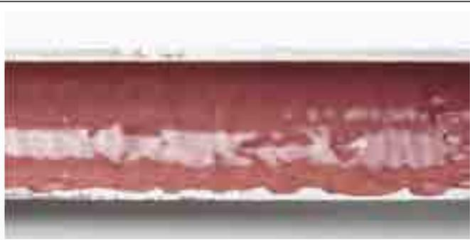
*Spessore indebolito della parete a causa della corrosione: nonostante il suo risanamento interno, la condotta non può essere considerata come nuova, a causa dell'indebolimento dello spessore della sua parete.*
