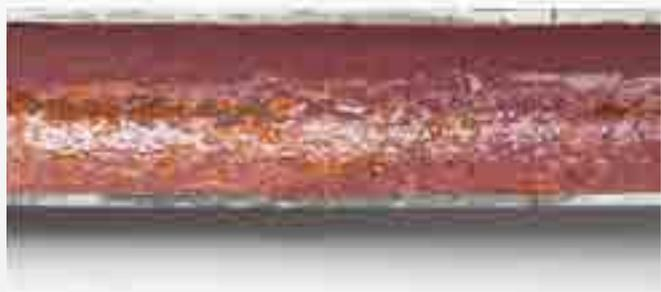
*Pulizia e rivestimento difettosi della condotta: sezione di una condotta inizialmente corrosa che è stata prima pulita, poi rivestita con resina epossidica. A causa di una pulizia insufficiente, il materiale di rivestimento non aderisce alla parete interna della condotta e la corrosione prosegue, non appena l'impianto è rimesso in funzione.*
